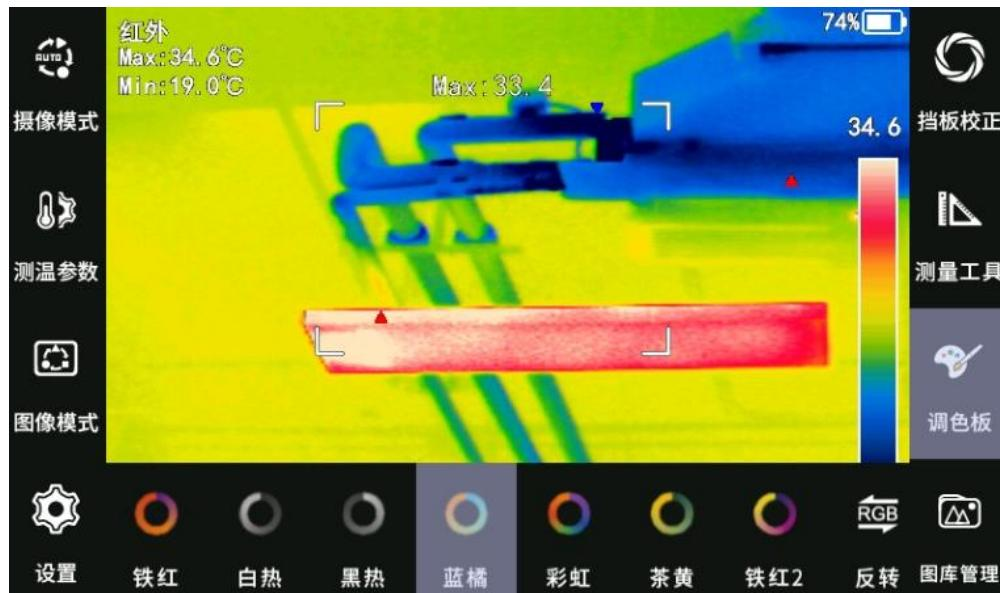
调色板：点击可以进行伪彩选择。分为：铁红，白热，黑热，蓝橘，彩虹，茶黄，铁红2，反转。选择调色板后点击反转，会将该调色板的温宽分布反转显示。
