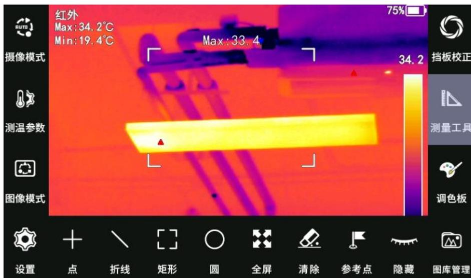
测量工具：点击测量工具出现测量工具二级菜单，包括测量工具 4 种类型（点，折线，矩形，圆），全屏，清除，参考点，隐藏。
