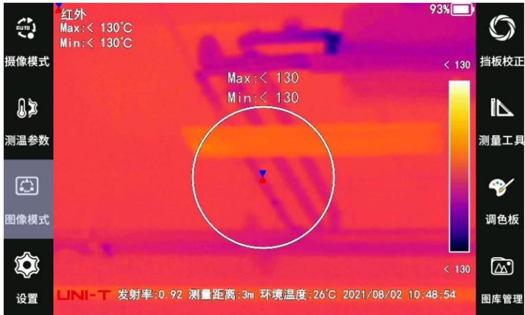
➤ 开机后，屏幕自动会生成一个中心位置测温区域-
