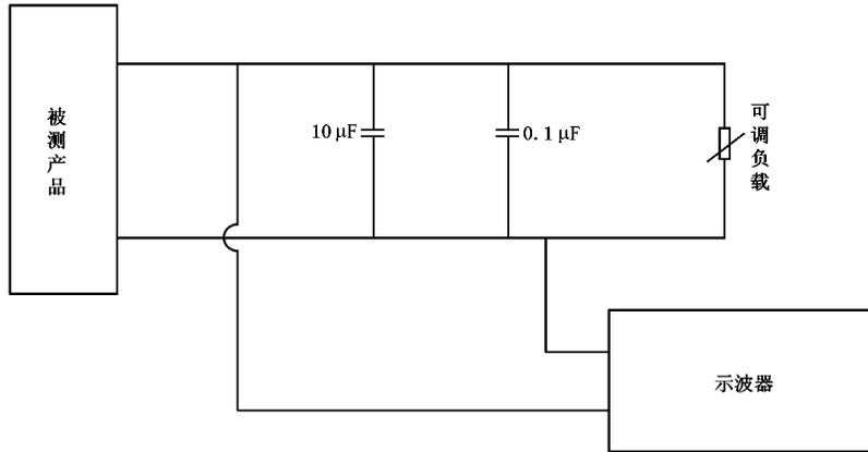
注 1:测试纹波电压所用示波器带宽应设定为 20 MHz;
