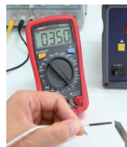
03. UT33C+可用K型热电偶测试
