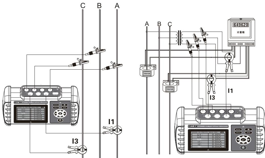
3. 测试三相四线电压、电流、相位、相序、频率、功率、功率因数等：
