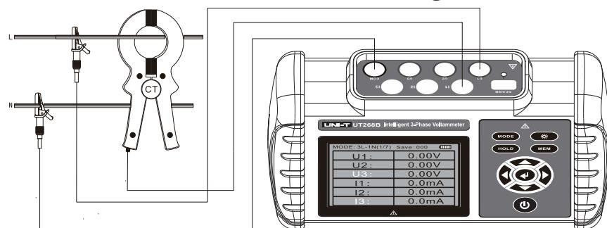
2. 测试三相三线电压、电流、相位、相序、频率、功率、功率因数等：
