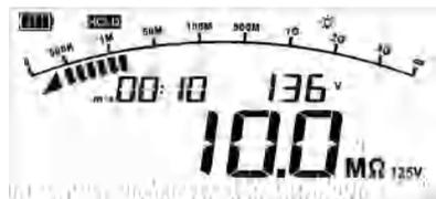
9.3.1.1.3 连续测量测试停止显示界面
