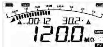
9.3.2.1.4 PV连续测量测试停止显示界面
