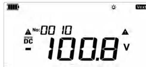
图9.3.3.4 直流负电压测量显示
