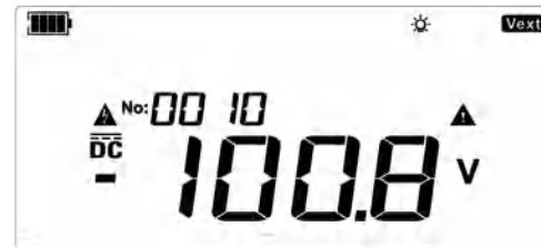
图 9.3.3.4 直流负电压测量显示
