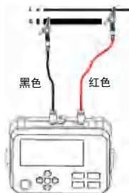
图 9.3.3.2 电压测量接线示意图
