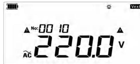
图9.3.3.3 交流电压测量显示
