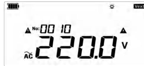
图 9.3.3.3 交流电压测量显示
