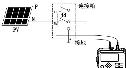
图10.3.2 P-N之间处于短路状态下测量
