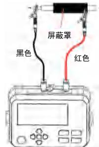
图10.1.1 常规两线测量接线示意图
