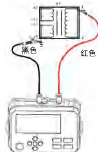
图10.2.1 一次绕组与二次绕组接地间绝缘电阻测试接线示意图
