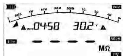
9.3.2.2.2 定时器测量检测外部带电
