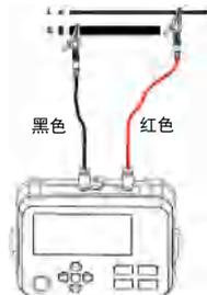
图9.3.3.2 电压测量接线示意图
