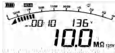
9.3.1.1.3 连续测量测试停止显示界面
