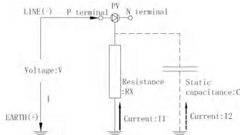
图9.3.2.1 PV Ω 测量原理
