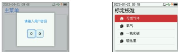
在气体校准页面可进行指定气体传感器的标零和标定操作。
