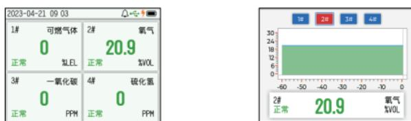
主界面顶端的通知栏显示了设备的工作状态，可通过图标的颜色及状态指示当前对应功能的状态。具体定义见下表：
