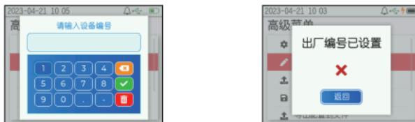
注意：当出厂编号已经设置时，将无法在设备上设置出厂编号。
