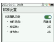
**注意：USB通讯功能是指设备通过USB连接到计算机后能否被计算机发现和识别并建立通讯，关闭后不影响设备通过USB充电。**
