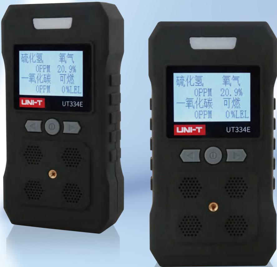
UT334E是一款便携式语音型四合一气体检测仪，是一种可连续检测泄漏气体浓度的安全型设备。采用了先进的集成电路技术、嵌入式微机控制，优质的气体传感器，具有优秀的灵敏度和出色的重复性；使用点阵式LCD显示器，支持中英文界面和中英文语音提示，使用及维护简单；外壳采用高强度工程塑料，抗振好，强度高，并具有防爆功能。
