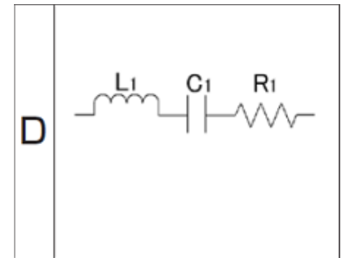
导电聚合物电容器 等效电路模型
