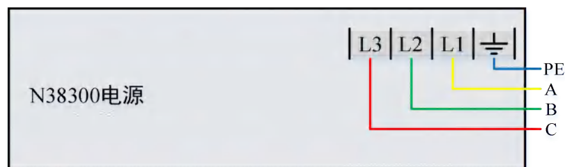
图 3-1 交流输入接线
