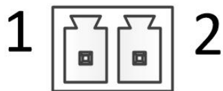
图 3-3 12VDC 供电输入端口
