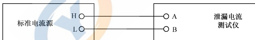
图 1 标准电流源法检定泄漏电流示值误差
