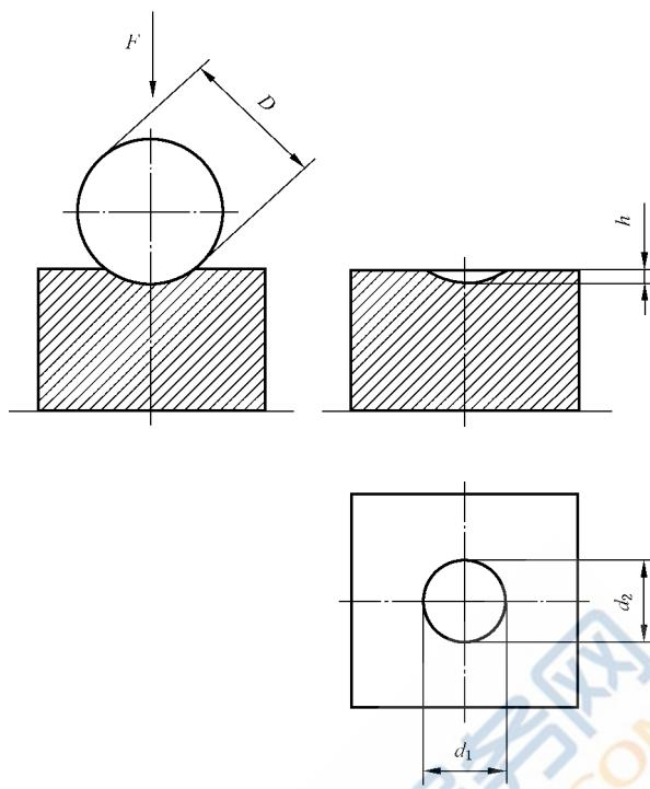
图 1 试验原理
