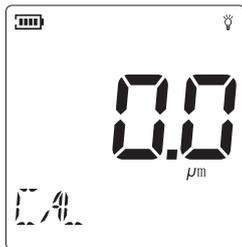
出现显示值0.0 μm，此时对铁基进行零点校准。
