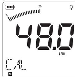
选择厚度在45~55间的标准片，按“▲”或“▼”键修改其显示值，使显示值与标准片的标称厚度一致，再将标准片放在铁基上进行校准。
