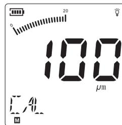
选择厚度在95~105间的标准片，按“▲”和“▼”键修改显示值，使显示值与标准片的标称厚度一致，再将标准片放在铁基上进行校准。
