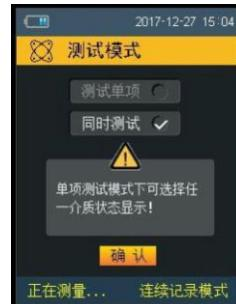
4.4.2 设置完成之后，轻按面板“RETURN/LIGHT”一次，退出测试模式选择设置，再次轻按面板“RETURN/LIGHT”一次，检测仪回到数据采集实时显示页面，并自动保存设置的数据。
