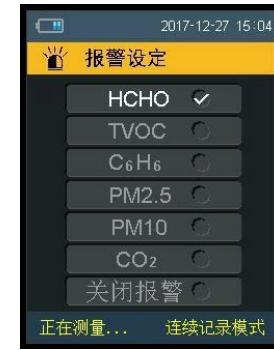
4.5.2 设置完成之后 , 轻按面板 “RETURN/LIGHT” 一次 , 退出报警设定” 项设置 , 再次轻按面板 “RETURN/LIGHT” 一次 , 检测仪回到数据采集实时显示页面 , 并自动保存设置的数据。
