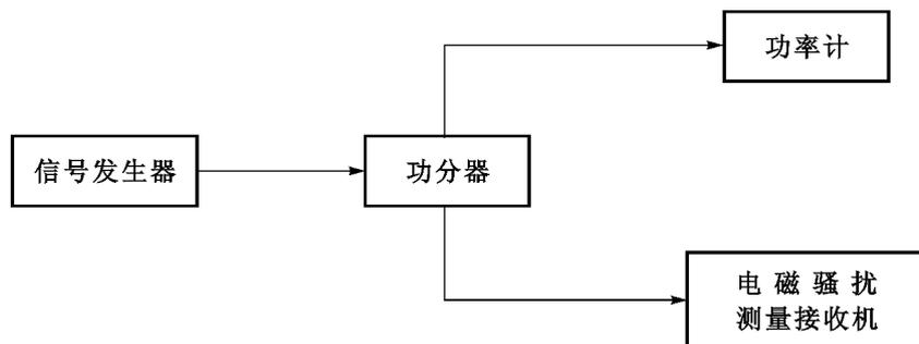
图4 第一中频镜像频率响应的校准
