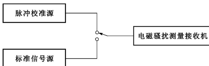
图 6 脉冲相应特性的校准
