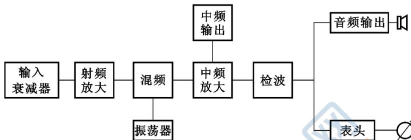
图 1 电磁骚扰测量接收机方框图
