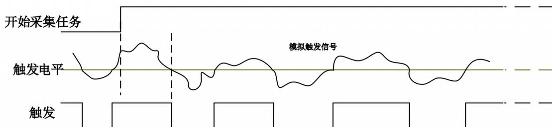
图4-8-6 模拟边沿触发--下降沿触发
