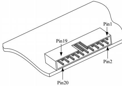
图 3-3-3 USB886X RTSI 的 Pinout 图
