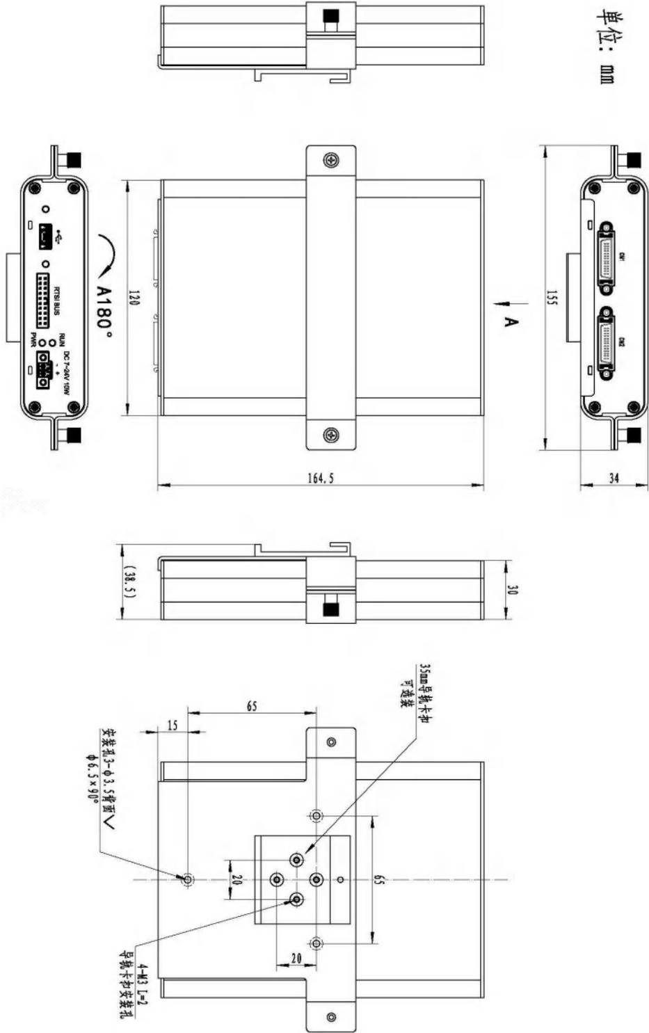
图 3-3-4 USB886X 板卡尺寸图
