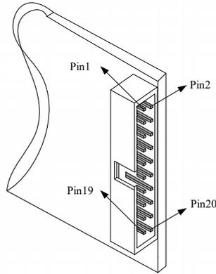
图 3-3-2 PCI886X RTSI 的 Pinout 图
