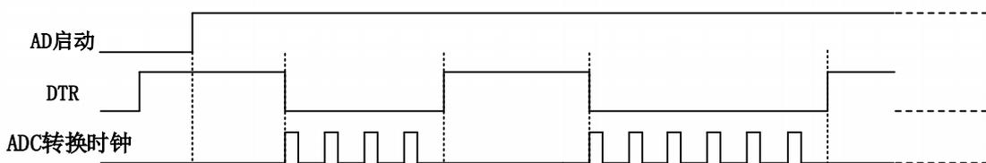
图 4-7-10 暂停触发—高电平暂停
