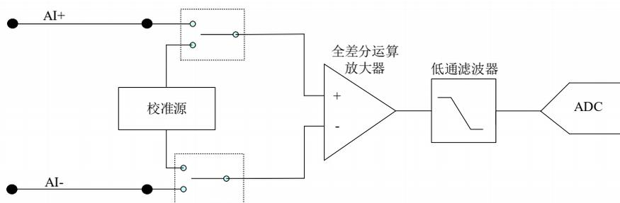
图 4-1-2 8862 / 8865 模拟输入功能框图
