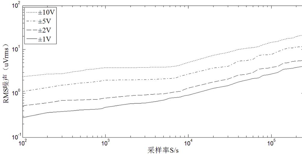
图 2-3-1 噪声与采样率关系图
