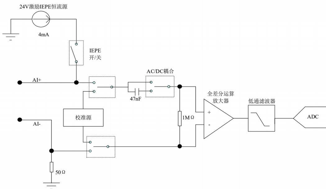
图 4-1-1 8862 / 8867 模拟输入功能框图
