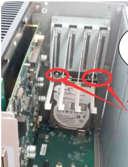
锁紧机箱上固定硬盘支架的两颗螺钉，装上机箱上盖，并且锁紧机箱后盖的两颗螺钉完成硬盘更换
