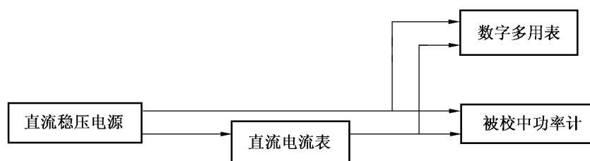
图 1 电流电压法校准框图
