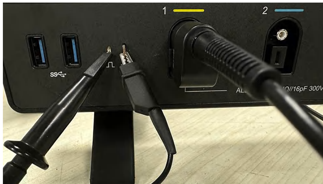
图2-11 探头连接方式
