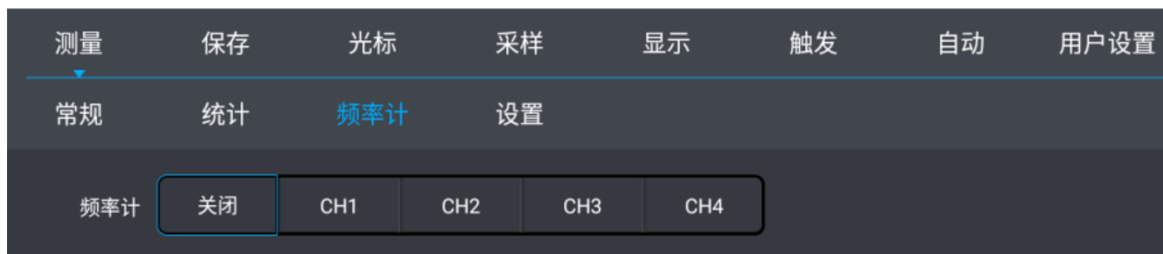
图 7-14 频率计测量菜单打开
