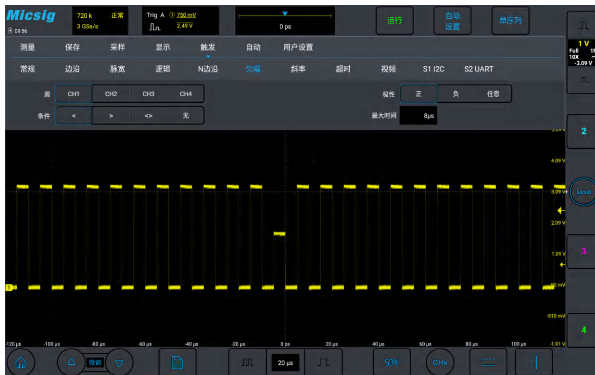
图 6-25 欠幅触发设置菜单
