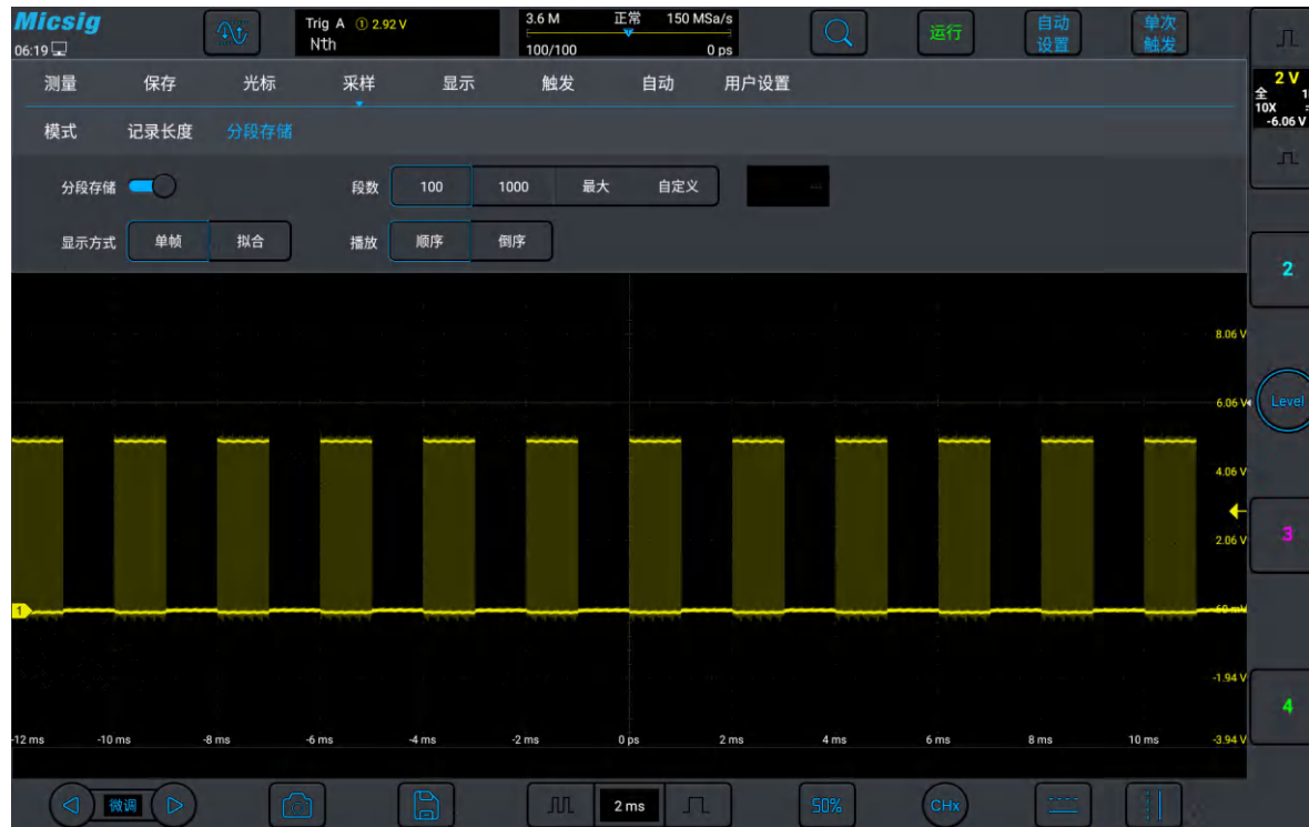
图 11-11 分段存储波形采集
