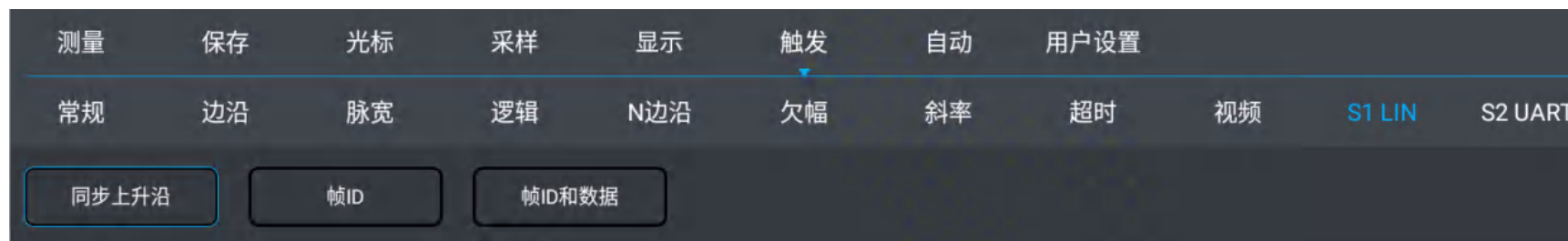
图 12-11 LIN 触发方式配置菜单
