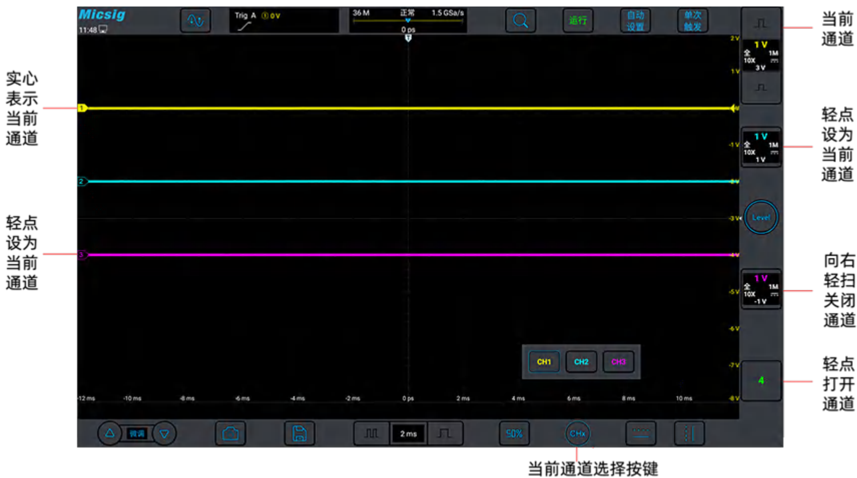
图5-4 通道的打开、关闭与切换
