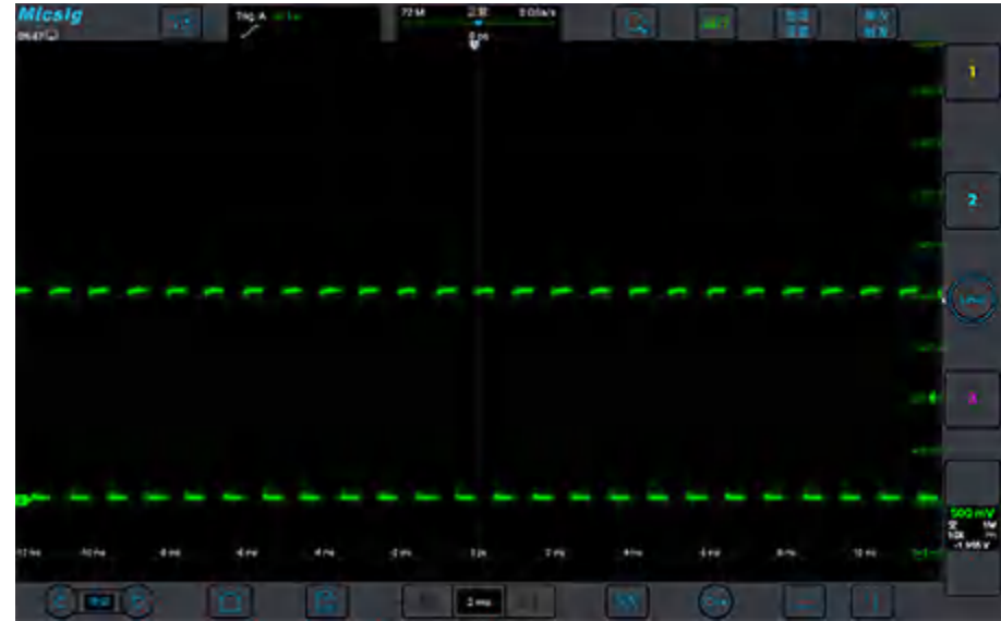
图 11-6 带毛刺的波形，正常采样模式
