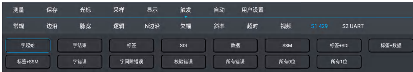
图 15-27 ARINC429 触发方式配置菜单
