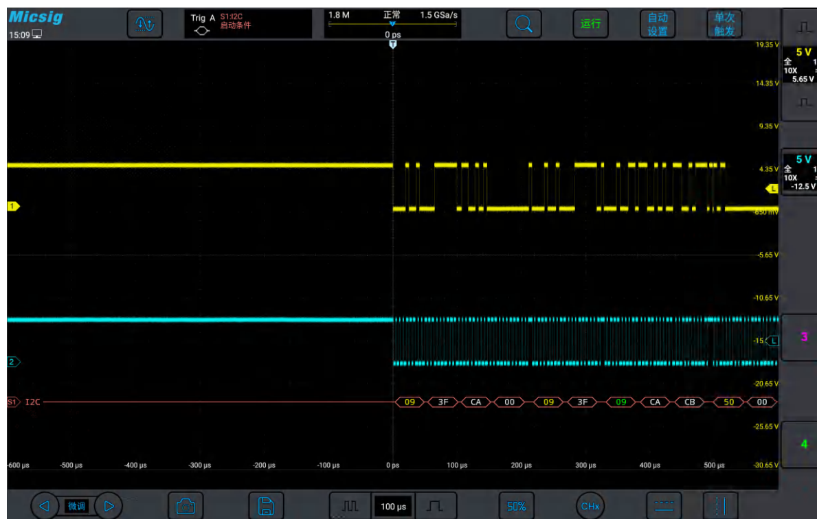
图 12-24 I2C 总线解码结果
