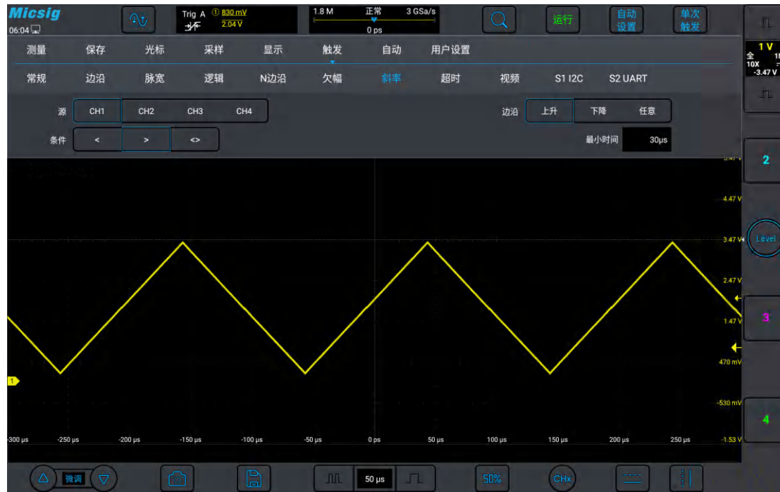
图 6-27 斜率触发设置菜单
