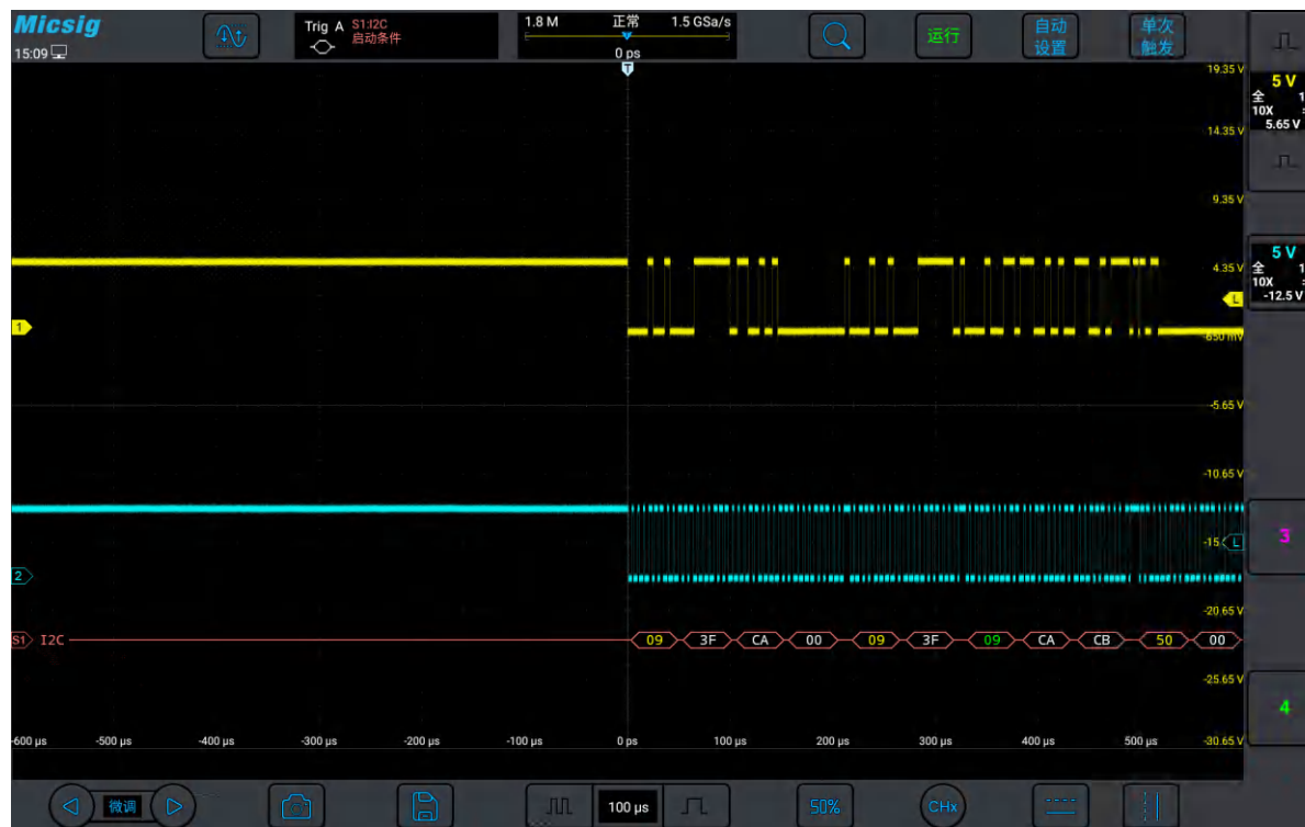
图 12-24 I2C 总线解码结果
