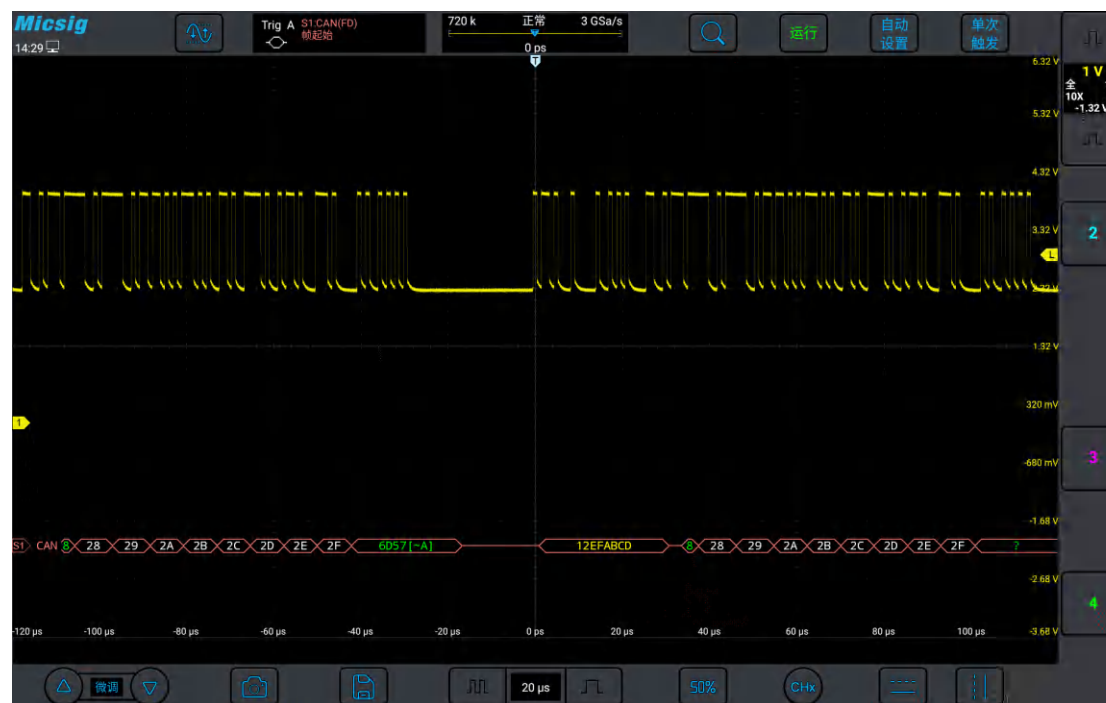
图 12-16 CAN 总线解码结果
