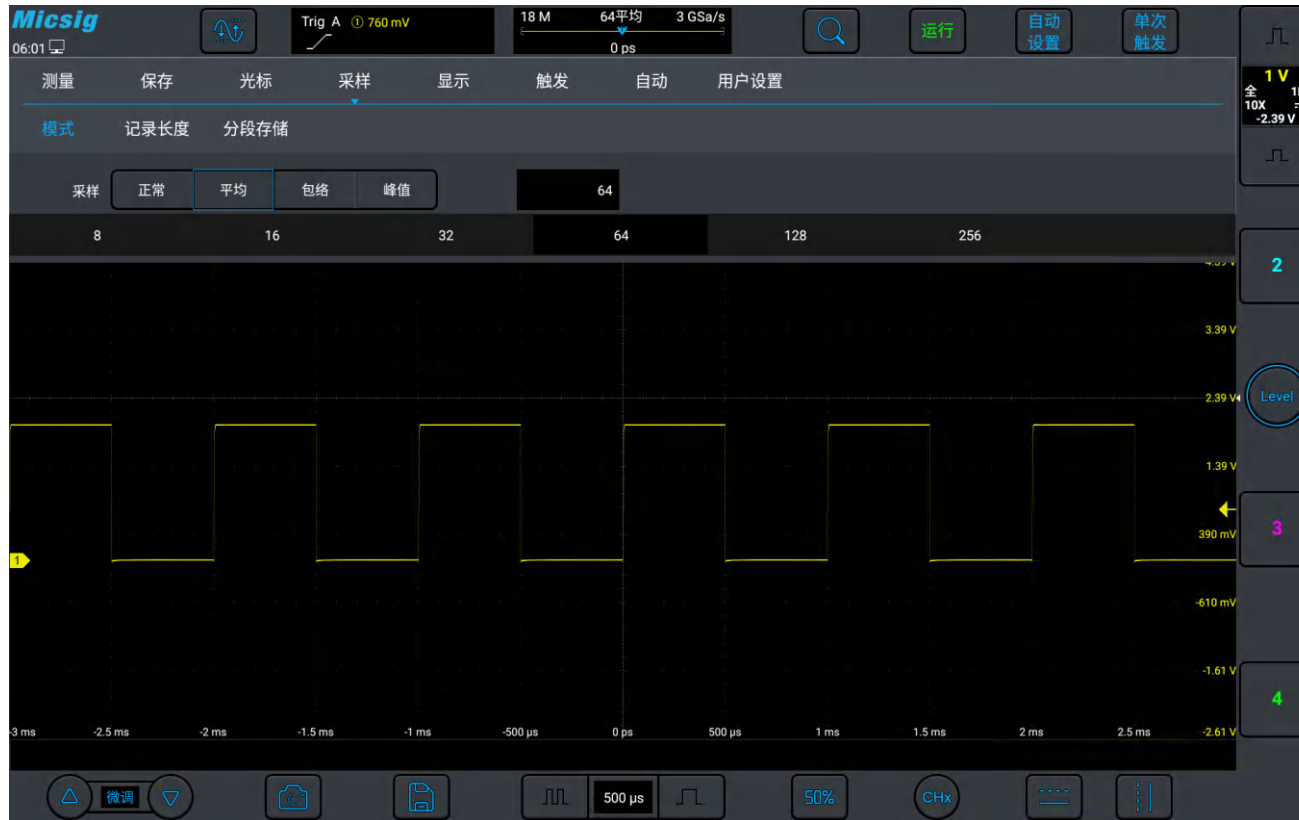
图 11-7 选择平均采样模式后的波形，平均数 64
