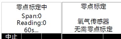
7. 使用“▲”键可随时中止零点标定过程。60秒后，若零点标定成功，则点击“√”键保存结果，如下图所示。若未弹出成功提示，则点击“▲”键中止并返回“标定&测试”屏幕。
