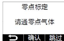
6. 零点标定气体准备好后，请点击“√”键，然后转到“标定浓度设置”菜单（如果是氧气传感器，则会提示“无需零点标定”）。如果放弃，请点击“▲”键返回“标定&测试”界面；在点击“▼”键跳过零点标定并进入“标定气体浓度”设置菜单。
