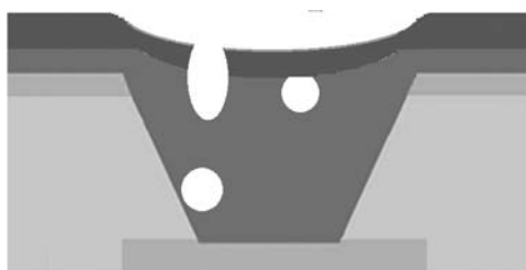
图9 填铜空洞 (不可接受)
