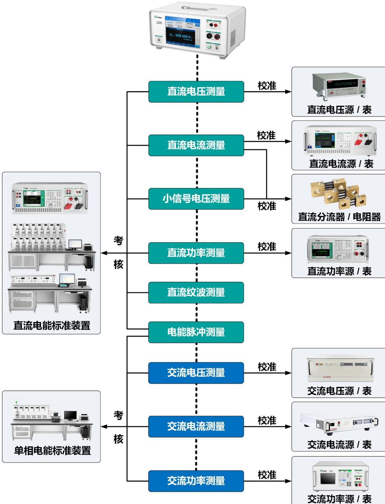
注：使用 TH1300 校准电测量仪表或电阻器时，需搭配对应功能的测试电源。
