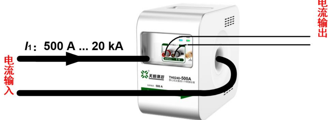
图(b) 电流穿心式连接示意图
