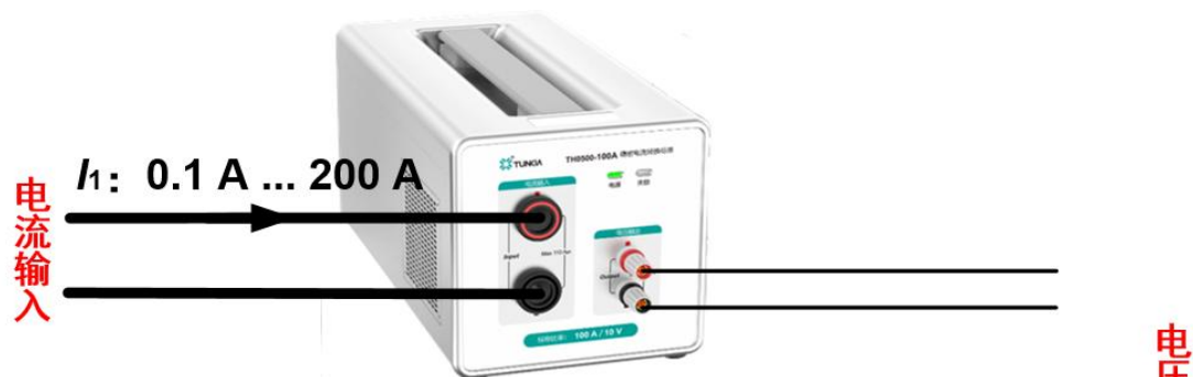
图(a) 电流直接连接示意图
