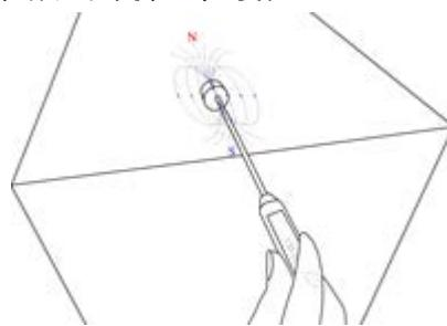
图为错误的测试方式，此时霍尔芯片的磁场成一定的角度，并非垂直，给测量带来了误差。
