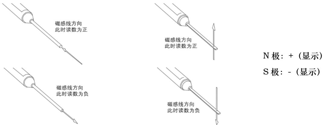
为达最佳效果，使用前仪器和探头应至少预热 5 分钟，预热 30 分钟后达到额定精度。严格测量前，探头应首先校零，以消除探头零点漂移或环境微小磁场的影响。温度也将影响探头精度，请尽量将探头置于 20℃附近温度下使用。
