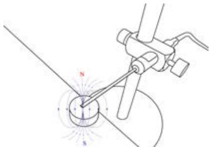
图为普通测试方式，通过手动调节测量方向和位置，但保证不了测量的重复性。
