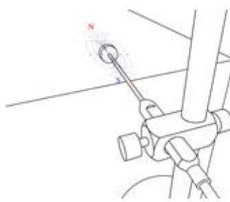
图为普通测试方式，通过手动调节测量方向和位置，但保证不了测量的重复性。
