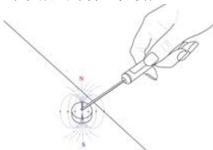
图为错误的测试方式，此时霍尔芯片的磁场成一定的角度，并非垂直，给测量带来了误差。
