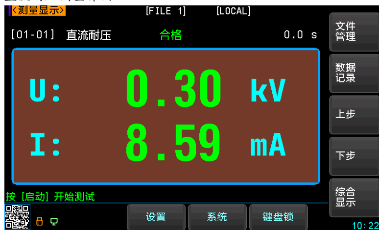
图 6-3 直流耐压测量界面
