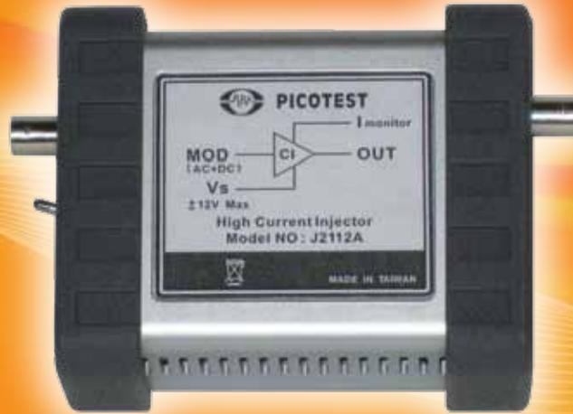
J2112A电流注入器是Picotest信号注入器系列之外的一种用途极其广泛的设备。与HM8150或其它类似函数发生器相结合，能够执行高达40MHz的小信号和大信号阶跃负载，上升/下降时间高达20ns，电流高达1A。可以控制上升和下降时间，任意波形用来激励注入器产生几乎任何特征模式的负载电流曲线。这适合模拟所有类型的负载条件，包括高速数字电路负载、电池放电曲线、或自发电流尖峰。
