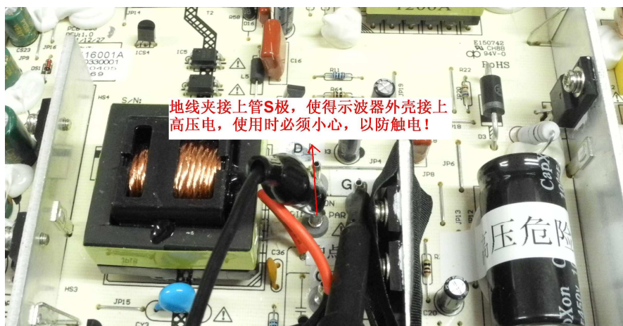
图 19 普通探头接上管 S 极，使得地线带高压
