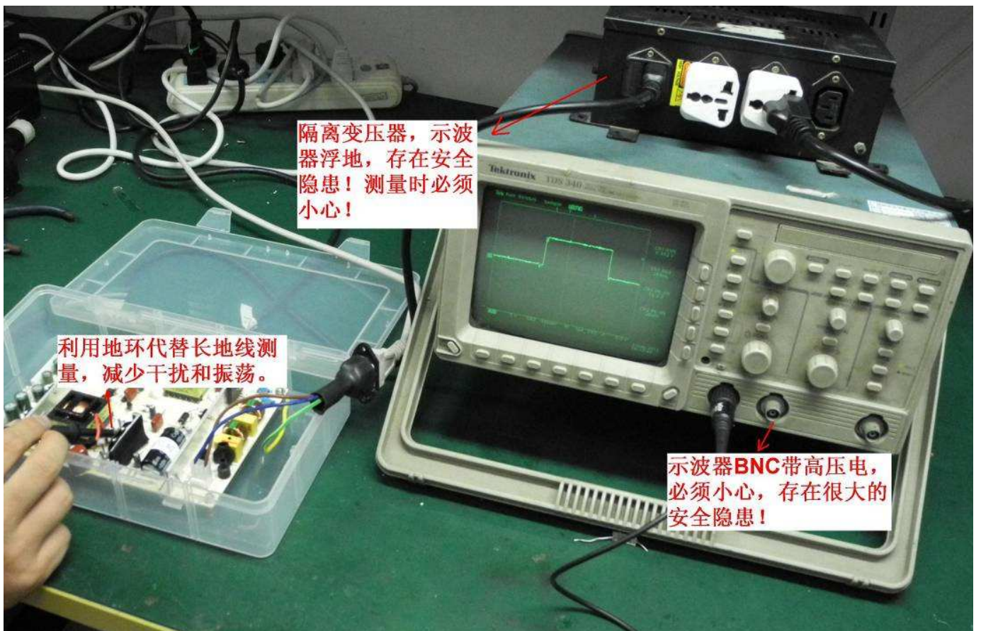
图23 利用地线环取代长地线的测量系统
