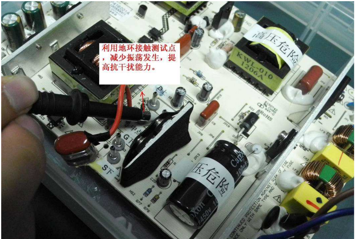
图22 示波器地线去掉，利用地环取代长地线，振荡减小，干扰最小，测量误差最小
