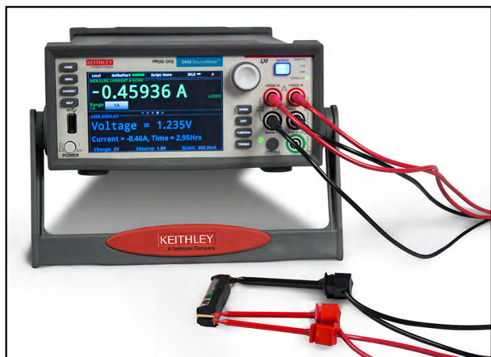
图1 利用2450型触摸屏数字源表进行电池测试
