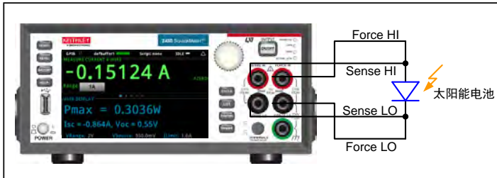
图1 2450型触摸屏数字源表与太阳能电池的连接
