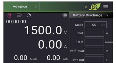
电池放电功能 (Battery Discharge)
