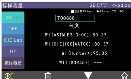
图40 标样测量下的白度显示界面
