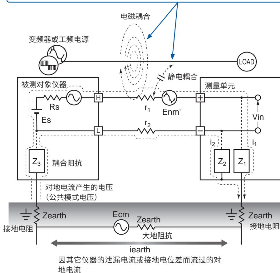
被测对象仪器侧的接地点与测量单元的接地点之间存在大地阻抗，地线与噪音源产生电容耦合而形成公共模式噪音。
