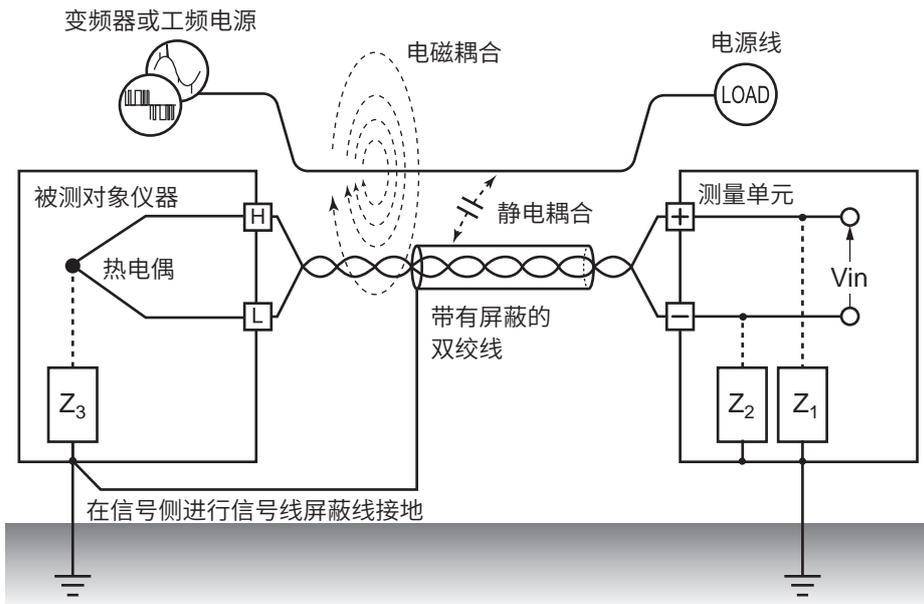
将信号线（热电偶）与成为噪音源的配线（电源线等）保持一定的距离。对于静电耦合来说，可通过屏蔽信号线并进行接地的方式加以隔断。
