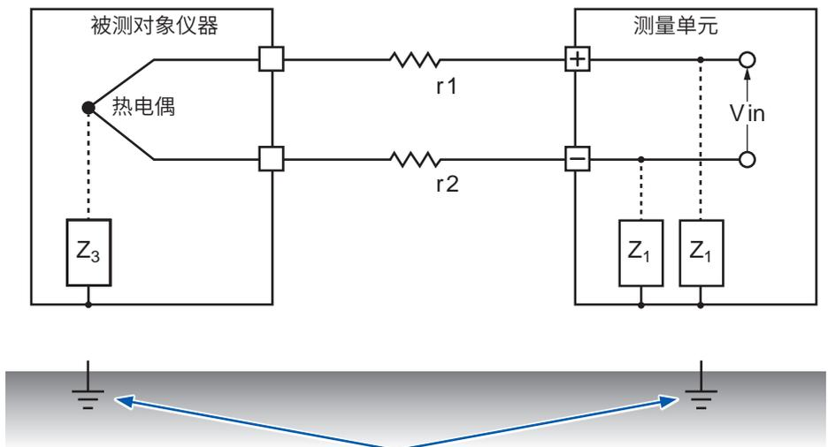
在热电偶温度测量中，如果被测对象仪器与测量单元双方均未接地，则会受到噪音的影响。虽然使用电池驱动测量单元时没有问题，但使用 AC 适配器时，请务必进行接地。
