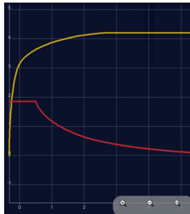
— 充电电流 — 充电电压 锂电池充电电压与电流变化实验
