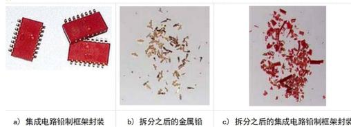
图 E.9 铅制框架元器件的拆分
