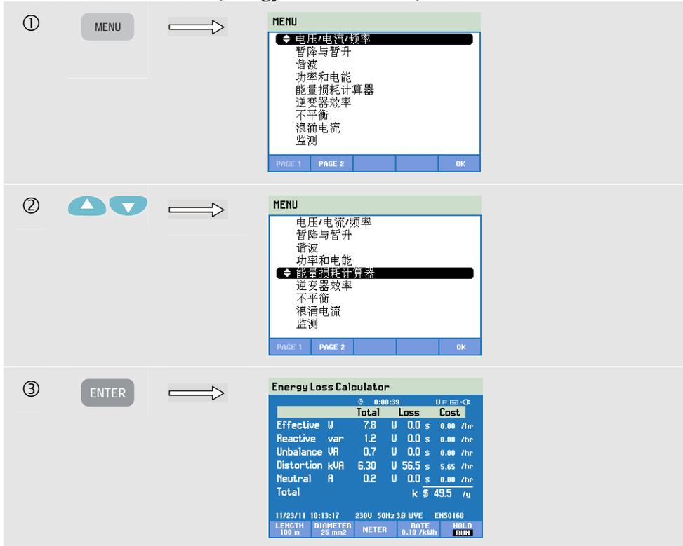
对电缆属性、关税和货币进行预设，可以按顺序输入设置 (SETUP) 键，F4 – 手动设置 (MANUAL SETUP)、F3 – 功能参数选择 (FUNCTION PReference)、F4 – 能量损耗 (ENERGY LOSS)。如何继续，请参阅第 24 章“设置”相关内容。
