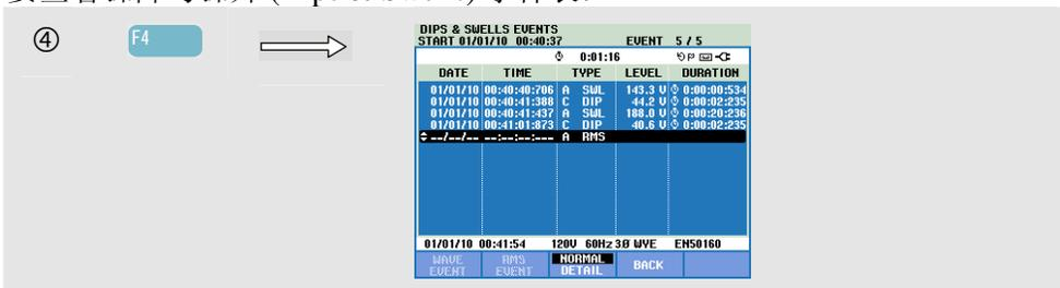
事件 (Events) 表列出相位电压的所有越限值。符合国际标准或用户自定义的阈值均可使用。阈值调整可通过设置 (SETUP) 键, F4 – 手动设置 (MANUAL SETUP) 和极限值 (Limits) 来完成。欲了解详细信息, 请参阅第 24 章“极限调整”相关内容。
