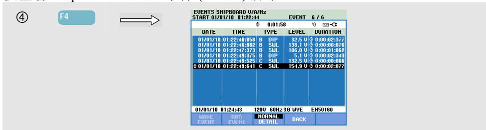
事件 (Events) 表列出相位电压的所有越限值。符合国际标准或用户自定义的阈值均可使用。阈值调整可通过设置 (SETUP) 键和极限值来完成。详细信息，请参阅第 23 章，极限值调整。
