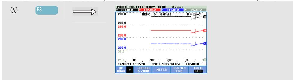
计量 (Meter) 屏幕中的所有值都被记录下来, 但计量 (Meter) 屏幕中每一行的趋势图每次只能显示一个。按功能键 F1 使用向上/向下箭头键选择行。
