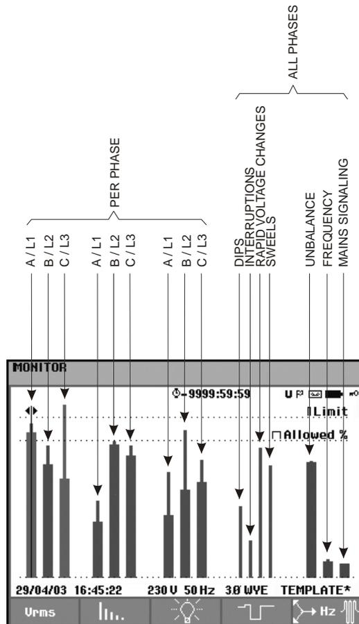
图 16-1. 电能质量监测 (Power Quality Monitor) 主屏幕
