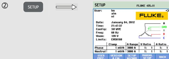
按设置 (SETUP) 打开设置入口屏幕。
