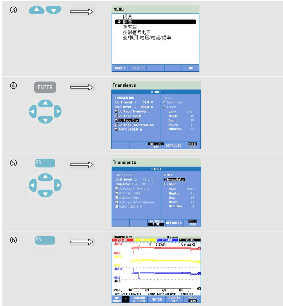
在开始 (Start) 菜单中，您可以选择一个触发事件或触发事件、瞬态电压 (Volt) 和电流 (AMP) 触发电平组合，以及选择立即 (Immediate) 或定时 (Timed) 启动测量。
