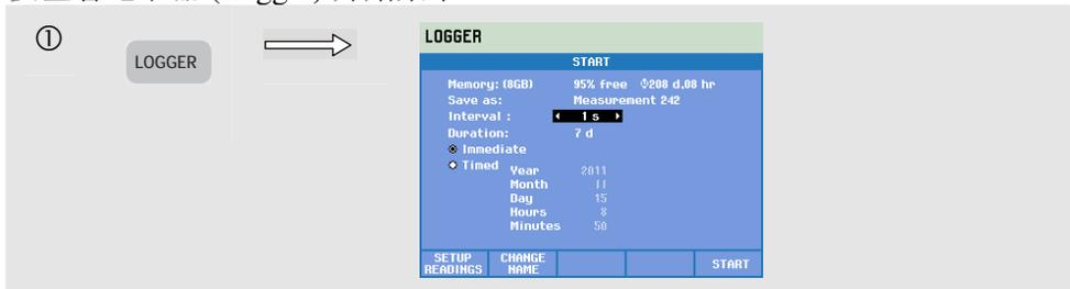
待记录的读数组可在功能键 F1 – 设置读数 (SETUP READINGS) 下的菜单中选择。默认频率 50/60 Hz 与 400 Hz 的读数选择列表不同。如将默认频率更改至 400 Hz 或从 400 Hz 更改至 50/60 Hz，读数选择列表将被设为默认值！
