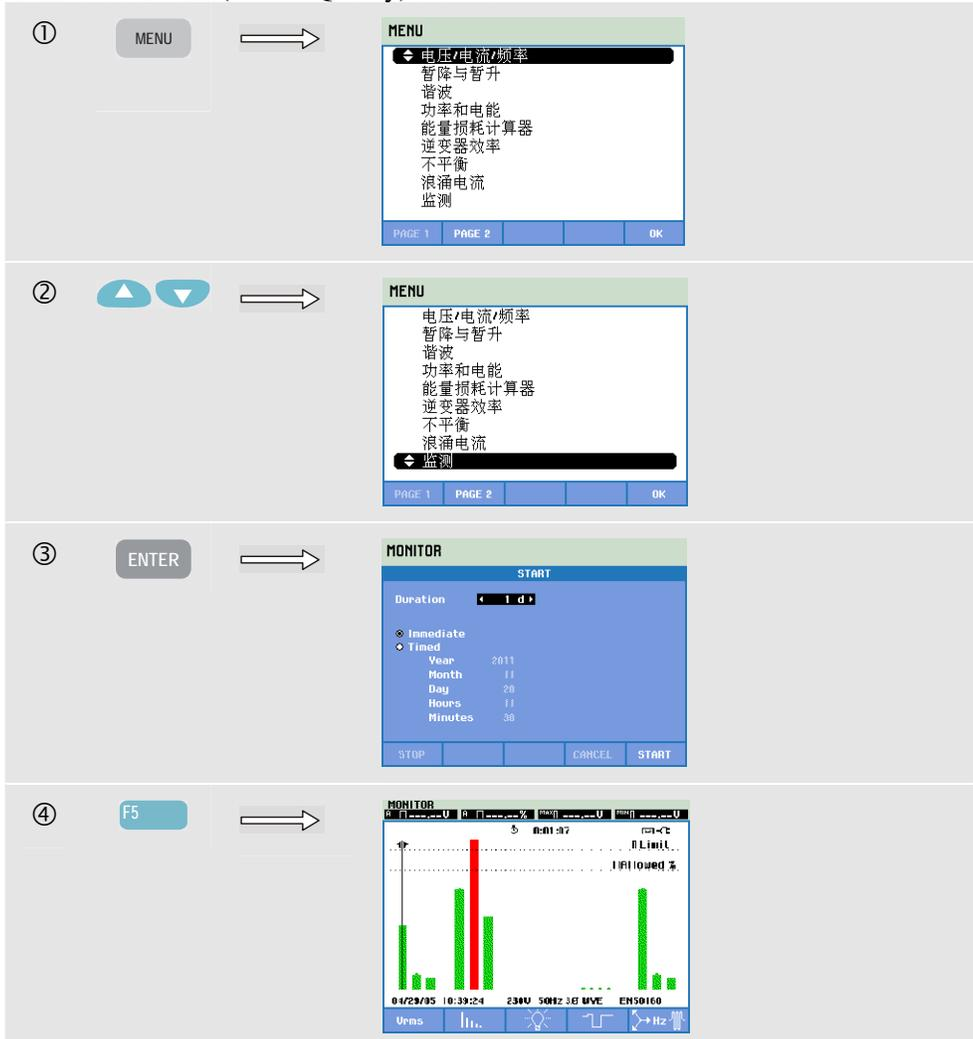
电能质量监测 (Power Quality Monitoring) 屏幕可通过菜单 (MENU) 键下的监测 (MONITOR) 选项打开。开始菜单可以设置立即 (Immediate) 或定时 (Timed) 启动。您可以使用向左/向右箭头键将光标定位在特定的条形图上。与条相关的测量数据显示在屏幕的表头部位。
