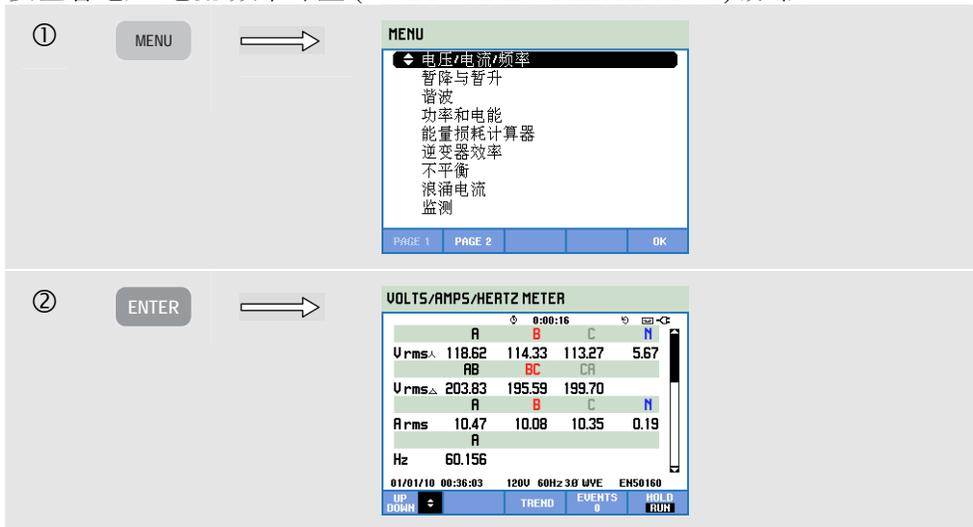
计量 (Meter) 屏幕概括列出了所有相位上的电压和电流。显示中性线到线路以及线路到线路的有效值 (RMS) 电压。频率和波峰系数也在屏幕中显示。波峰系数 (CF) 表示失真的程度：波峰系数 1.41 表示无失真；高于 1.8 表示高度失真。在用其它测量模式详细检查系统前，可利用该屏幕初步了解电力系统的性能。计量屏幕中的列数取决于电力系统的配置。使用向上/向下箭头键滚动计量 (Meter) 屏幕。
