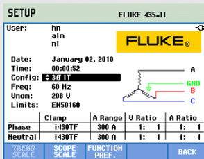
返回到设置 (Setup) 入口屏幕。新的配置显示在配置 (Config) 后，同时相关的配置符号也显示在屏幕的右侧。
