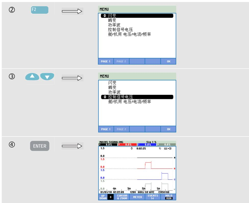
曲线从右侧逐步形成。表头部位的读数与右侧所绘的最新数值相对应。利用向上/向下箭头键，您可以标称线电压的百分比或 3 秒平均电压 V3s 来作为读数单位。电力线发信功能不使用中性线，但为了方便故障诊断，中性线也一并显示。
