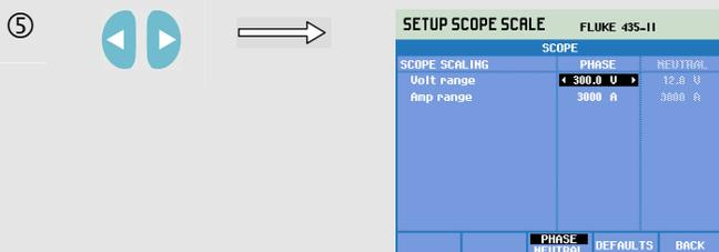
使用向左/向右箭头键来增加（例如增加至 300 V）示波器显示屏的电压范围。
