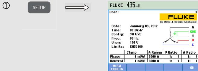
当前配置在配置 (Config) 之后以文字和图表方式指示。
