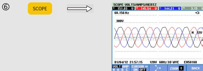
返回至示波器显示屏：各相位的电压波形在视图窗口内。
