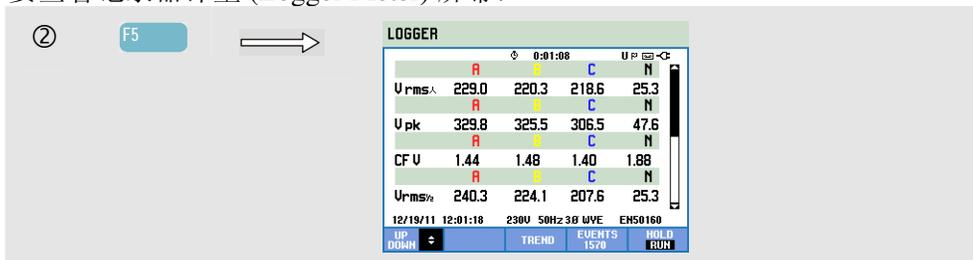
该屏幕显示所有记录器功能的当前读数。使用向上/向下箭头键滚动计量 (Meter) 屏幕。
