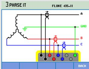
此图表详细显示了如何将分析仪与所测电力系统连接起来。
