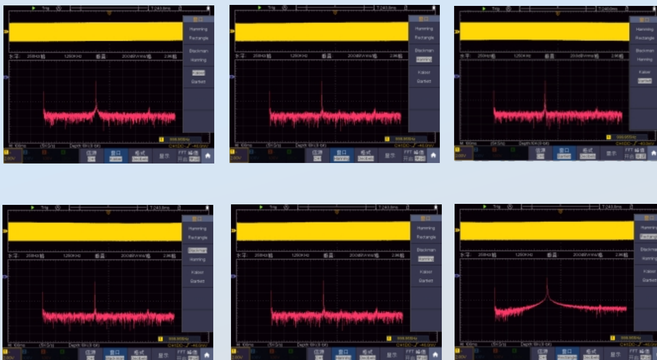
以上显示波形为1kHz 正弦波的6种窗体函数FFT 变换。
