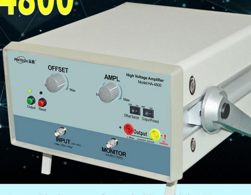
高压放大器是非常实用的高电压讯号放大器，它具有简易的操作，超高电压输出(4800Vp-p)等优点，连续输出电流最大可达50mA。输出保护开关，当选择保护输出时能确保本机不会外部短路，或外部电压回馈而导致损坏，因此可大幅降低不良率，延长本机的使用寿命。
