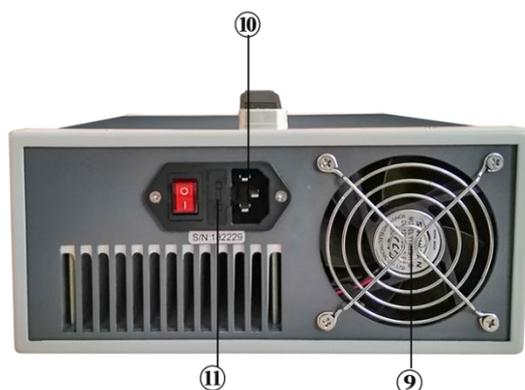
⑨散热风扇：吸出型，使用 24V/DC/0.25 A
