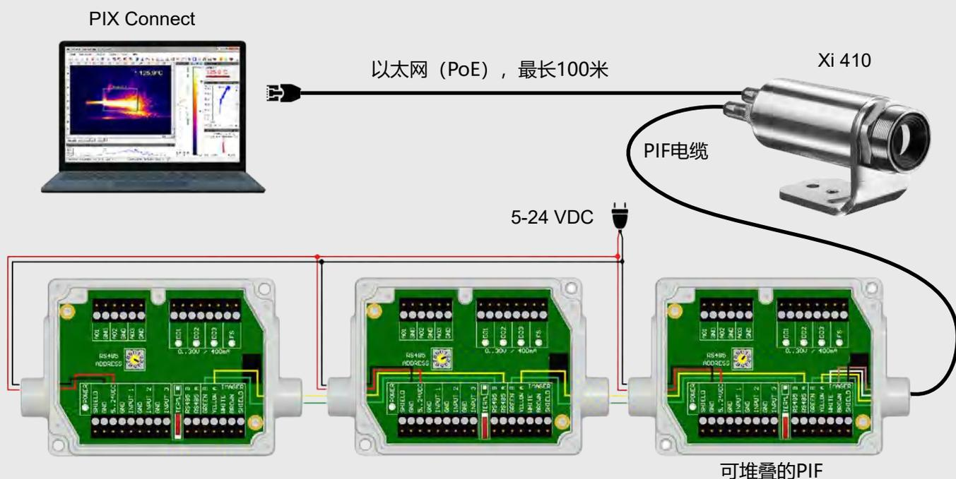
自主操作 (无PC), 最多有3个模拟输出/报警输出
