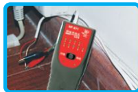
将发射器和待寻电线端连接好
