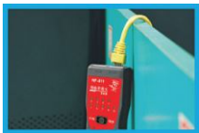
将发射器和待寻网线端口连接好
