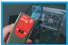
将发射器和待寻网线端口连接好
