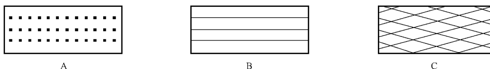
A:雾状凝露 B:珠状凝露 C:流水状凝露
