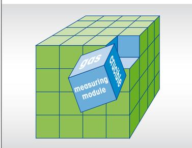
每个仪器特定的参数集主要描述温度、加热速率、坩埚、气体和标准设置的传感器类型之间的关系。该模块始终使用正确的校正参数，不会受选用的坩埚类型或者在测试过程中切换气氛的影响。
