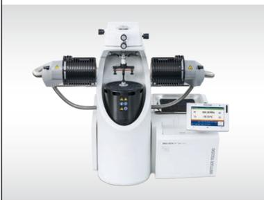
DMA/SDTA 1+ 可同时测量力和位移; 因为该仪器能够记录真正作用于样品的力, 所以保证了高准确性。
