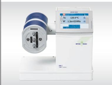
DMA 1 的独特之处在于可旋转的测试头。可以在所有标准形变模式下, 甚至在液体或设定的相对湿度条件下进行测量。
