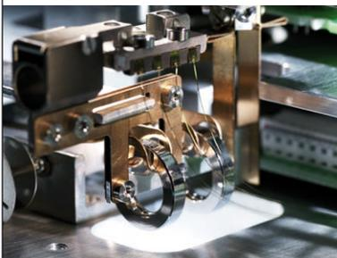
TGA 的核心是天平单元。我们的 TGA 仪器采用世界上非常高端的微量和超微量天平。
