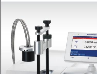
DSC 仪器可结合使用多种选项, 如光量热法、显微法或化学发光法。
