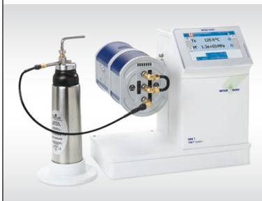
DMA 1 大幅提升了冷却性能: 样品可在不到 10 分钟时间内从室温快速冷却至  $-190^{\circ}\text{C}$ , 且液氮耗量很低 — 三个到  $-100^{\circ}\text{C}$  的冷却循环的耗量不到 1 升。
