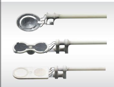
如果想在测量重量变化的同时同步测量热流 (DSC), 您可以在三种不同的传感器中选择配置。
