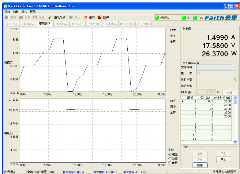
图 7-3 CC 下的序列测试时的电压电流曲线图
