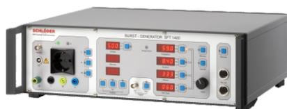
**SFT 1400** 其清晰排列的前面板和发生器的设置使用户能进行省时和优化的测试，标准的测试级别1, 2, 3, 4是预编程的，可直接存储在命名为1-4的测试内存中。
