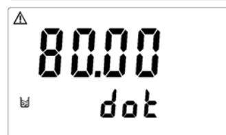
6. 此時主機正在讀取傳感器訊號作內部校正狀態。
