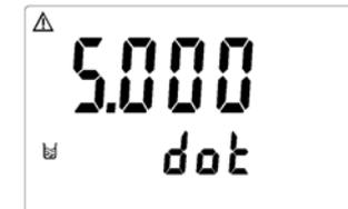
7.3.2 此時主機正在讀取傳感器訊號作內部校正狀態。
