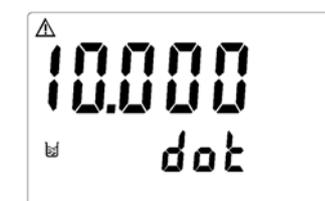
2. 此時主機正在讀取傳感器訊號作內部校正狀態。
