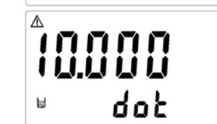
7.3.4 此時主機正在讀取傳感器訊號作內部校正狀態。
