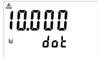
7.4.3 此時主機正在讀取傳感器訊號作內部校正狀態
