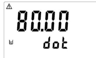
7.3.6 此時主機正在讀取傳感器訊號作內部校正狀態。
