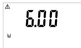
3. 此時主機正在讀取傳感器訊號作內部校正狀態
