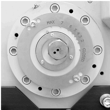
用于连续间隙宽度设置的刻度
