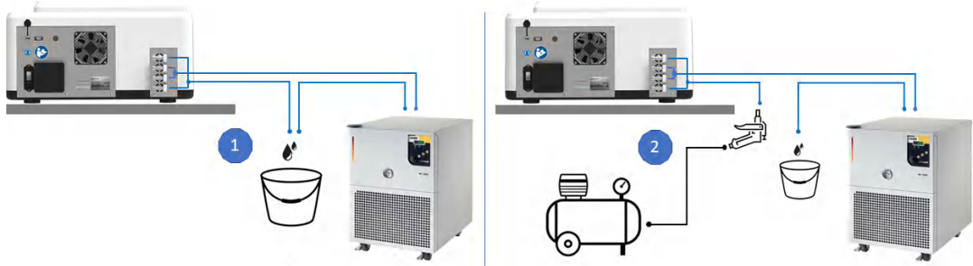
图 10: 用压缩空气机组排空管道
